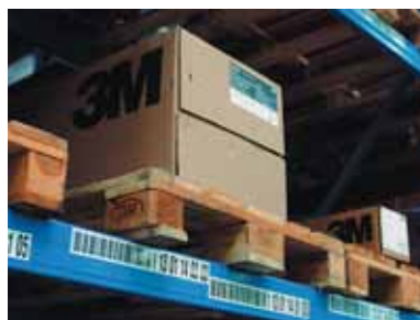
3M 3929 pro řízení zásob. Čárové kódy lze opticky snímat ze vzdáleného místa
