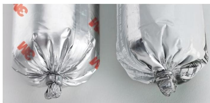
Lisované konce na salámových obalech 3M (na rozdíl od drátěných spon u jiných značek) pomáhají prodlužovat skladovatelnost, protože chrání před vnikáním vlhkosti, která může způsobit předběžné vytvrzení a znehodnotit výrobek.
